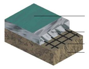
верхний упрочнённый слой бетона либо полимерное покрытие по выбору
